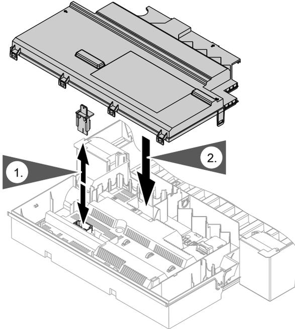
1. Vorhandenen Kessel-Codierstecker herausziehen und Befestigungsband vom Leitungsbaum trennen. Neuen Kessel-Codierstecker einstecken und Befestigungsband am Leitungsbaum befestigen.
