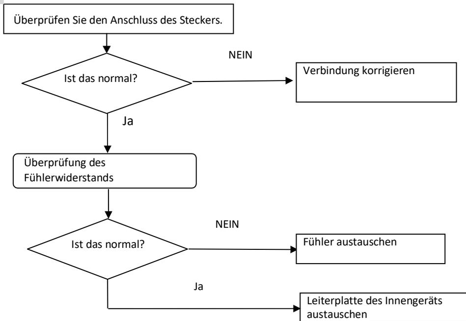
Methode zur Überprüfung des Fühlerwiderstands:
